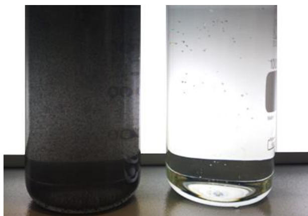
Figura 2. Imagem da amostra do efluente bruto e da corrente de permeado obtido após a filtração com membranas cerâmicas e poliméricas.
