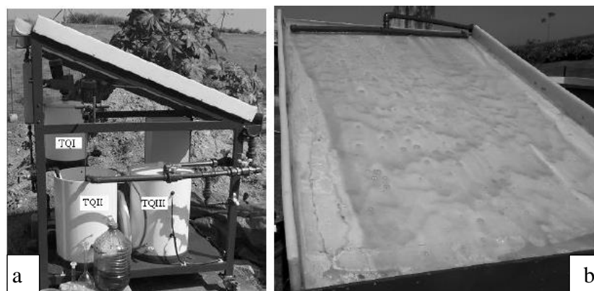
Figura 1. Unidade piloto solar. (a) detalhamento dos tanques (b) detalhamento do reator, tipo filme descendente.
