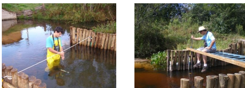
Figura 2. Medições de vazão com molinete no Ribeirão da Onça na seção de medição, em duas possíveis situações: com o operador à jusante do equipamento e sobre uma passarela.
