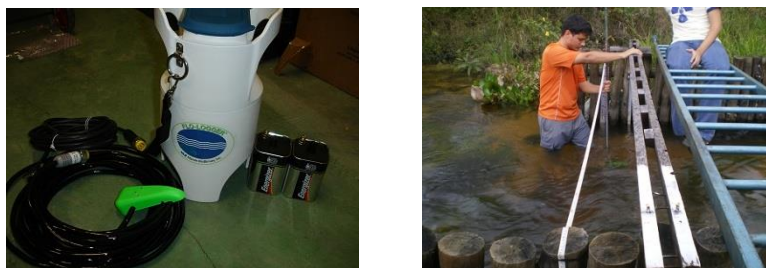
Figura 5. Medidor de velocidade eletromagnético (sensor verde). O cilindro branco contém o datalogger e baterias. A figura da direita apresenta o posicionamento do sensor no ribeirão.
